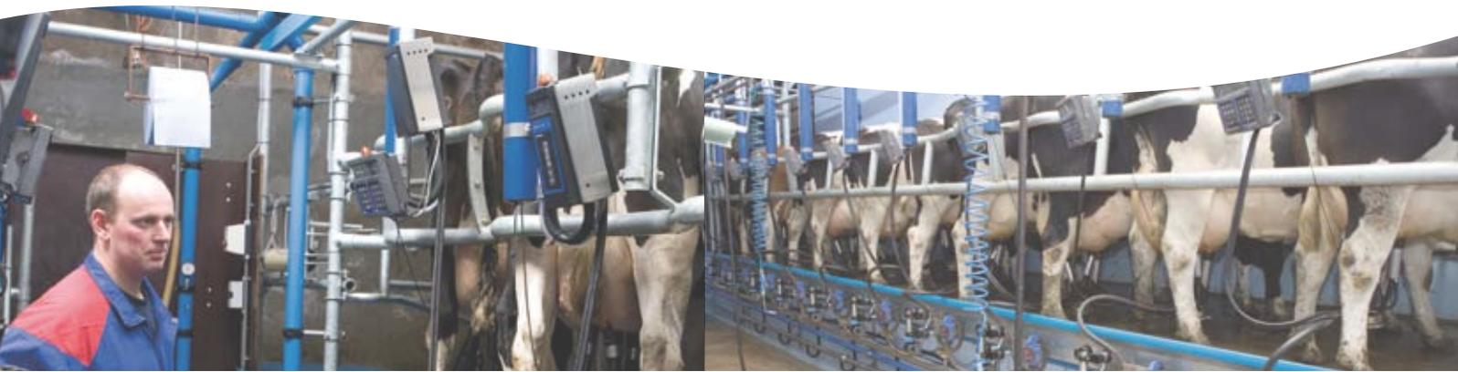
Lice arrière sinusoïdale et barre anti-coups de pattes
