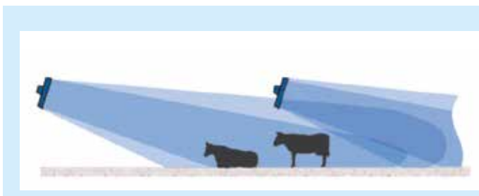
Wurfbilder des DDF1200S (links) und DDF1200P (rechts) bei voller Leistung und 20° Neigungswinkel (Abb.: LfL Grub)
